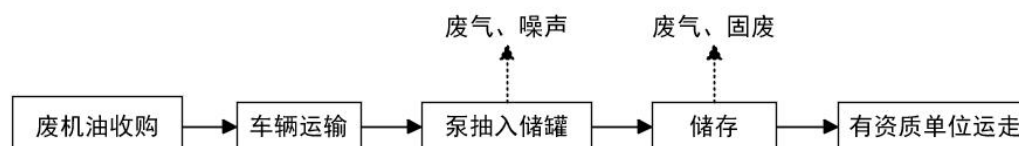
图 2-3 废机油回收工艺流程及产污分析图
