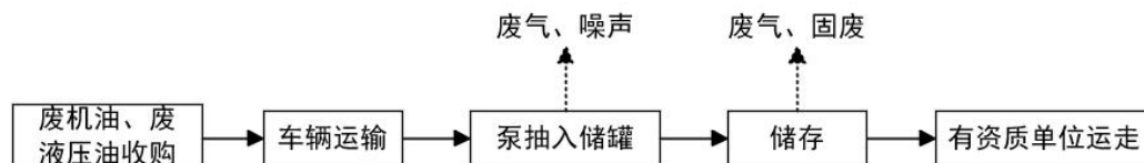
图 2-2 废机油、废液压油回收工艺流程及产污分析图
