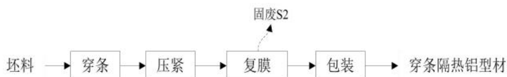
图 2-8 穿条铝型材生产工艺流程及产污环节
