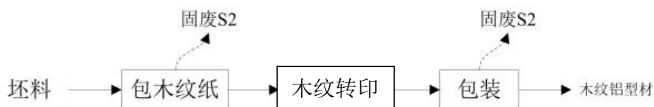
图 2-9 木纹铝型材生产工艺流程及产污环节
