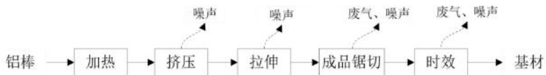
图 2-5 基材（白材）生产流程图
